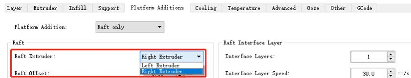
Figure 6.24: Sélectionnez une extrudeuse pour imprimer le radeau.
