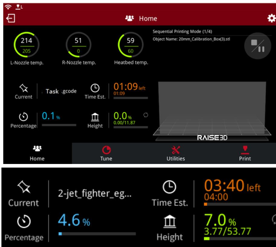
Figure 4.87: Interface à écran tactile lors de l'impression séquentielle.
