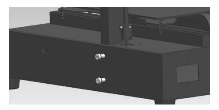
Étape 4. Mettez les 2 pièces M4x6 Vis de guidage linéaire rail sur le côté gauche,
